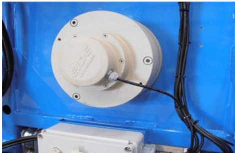
FRENO PARACAIDAS CON REARME AUTOMATICO
