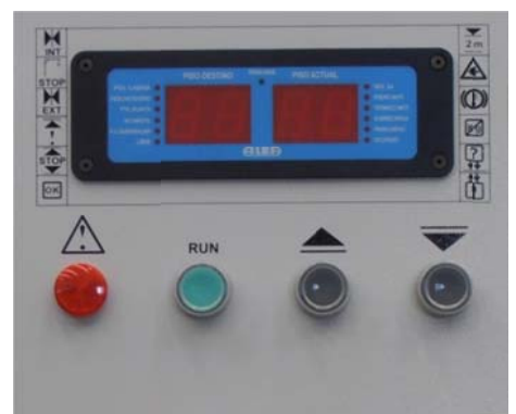
PANTALLA CON DIAGNOSTICO DE FALLOS
