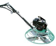
Las allanadoras **CIPSA** de operador a pie se utilizan para el acabado de pisos en donde se requiere planicidad y terminados profesionales. Las allanadoras sencillas se utilizan para obras pequeñas y medianas.
