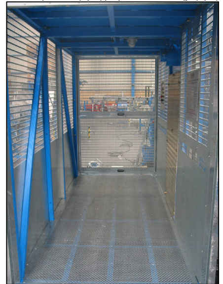
Interior en acero galvanizado / Hot galvanized inside
