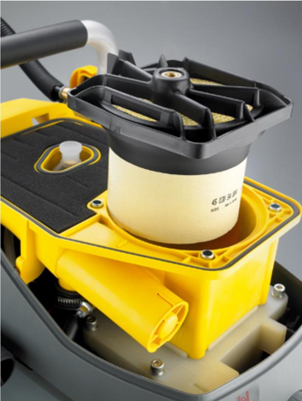
A continuación, el aire aspirado pasa por un separador ciclónico donde se eliminan la mayoría de partículas de suciedad. Después pasa al prefiltro de espuma de goma. Al finalizar, el aire ya limpio llega al filtro principal. Este procedimiento multiplica la vida útil del filtro de aire. Además, la pérdida de presión es mínima, por lo que el rendimiento del motor es elevado y constante.
