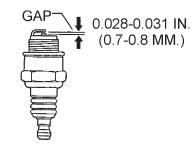
Figure 18. Spark Plug Gap
